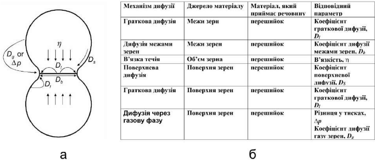
Рис. 1.18. Принципова схема механізмів дифузії (а) та шляхів переносу маси (б) при спіканні кераміки [121].
