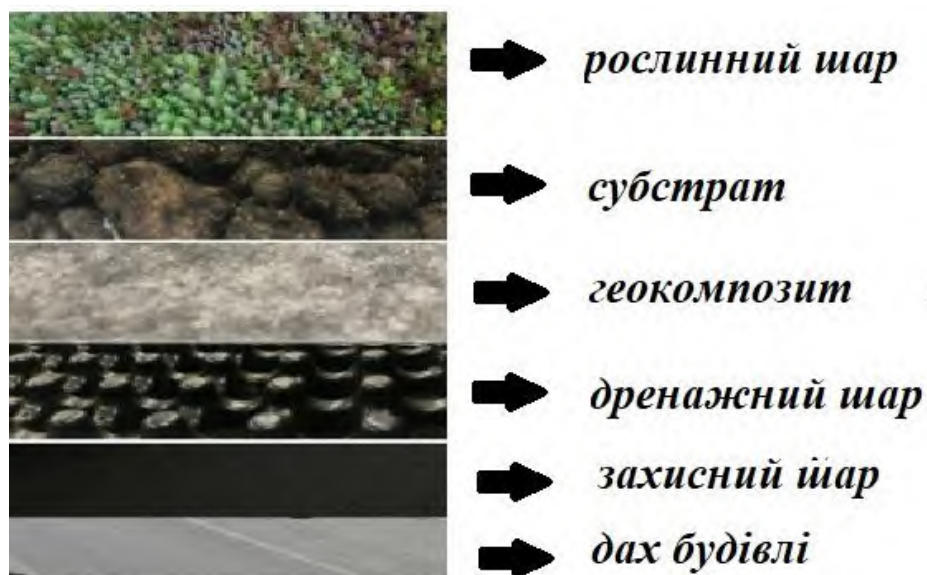
Рис. 4.4. Схематичне зображення екстенсивного даху
