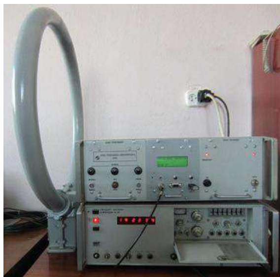
Рис. 2.4. Зовнішній вигляд системи для дослідження іоносферних варіацій фази й амплітуди сигналу станції РБУ служби еталонних сигналів частоти та часу. Верхній прилад – приймач ПК-66 з магнітною антеною (зліва) та мікроконтролерним вимірювачем фази; нижній – рубідієвий стандарт частоти Ч1-69
