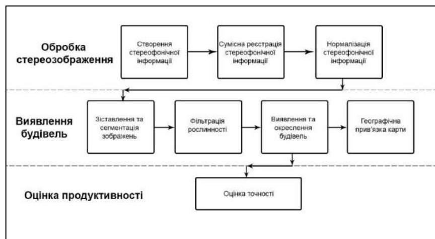
Рис.1.8. Принцип стереофонічної методології виявлення будівлі (побудовано автором за [186]).
