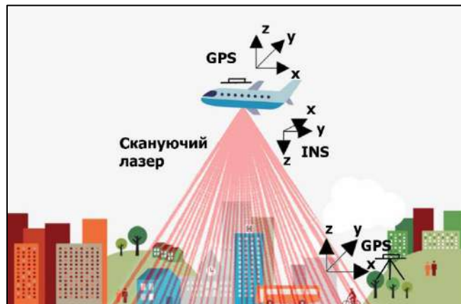
Рис. 1.11. Компоненти апаратного забезпечення лідача (побудовано автором за [184]).
