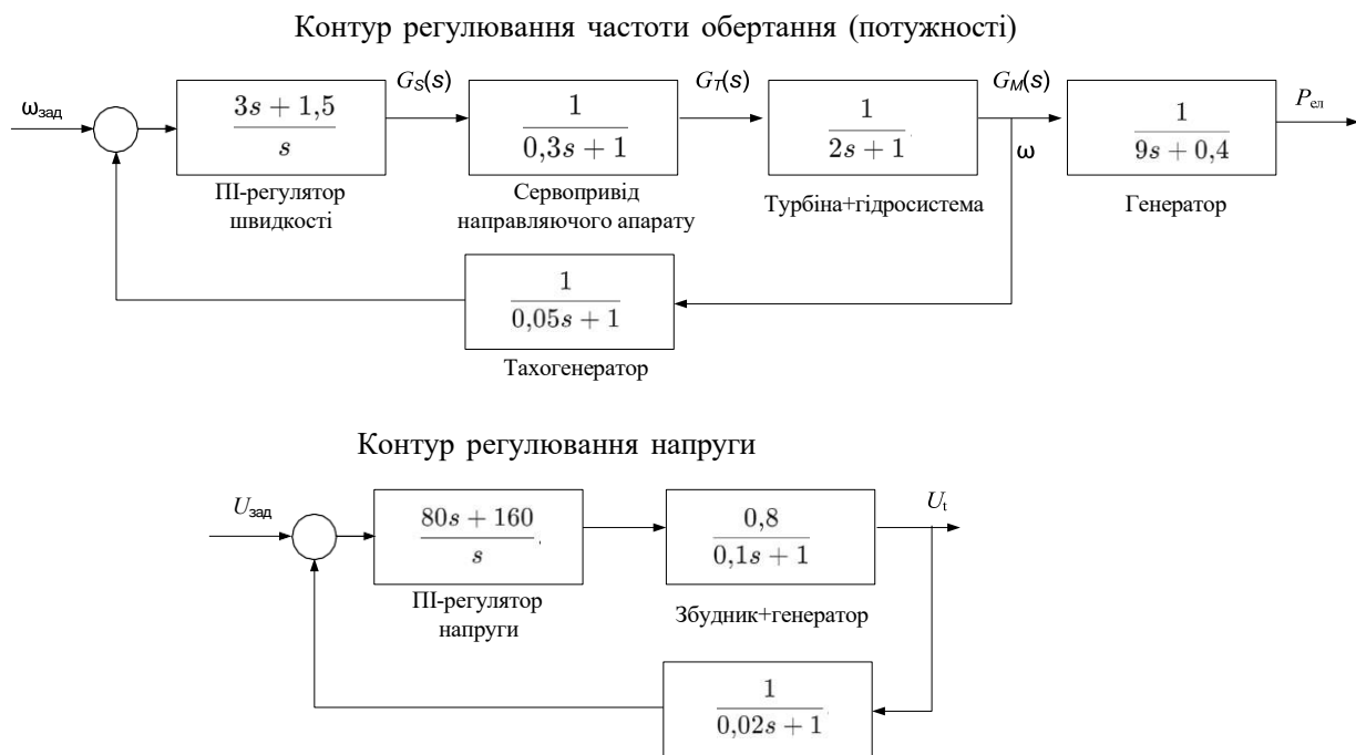
Рисунок 3.5 – Структурно-логічна схема системи керування ГЕС малої потужності
