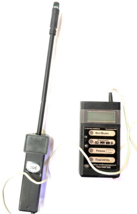
Рис. 3.1. Комбінований прилад «ТКА-ПКМ»
