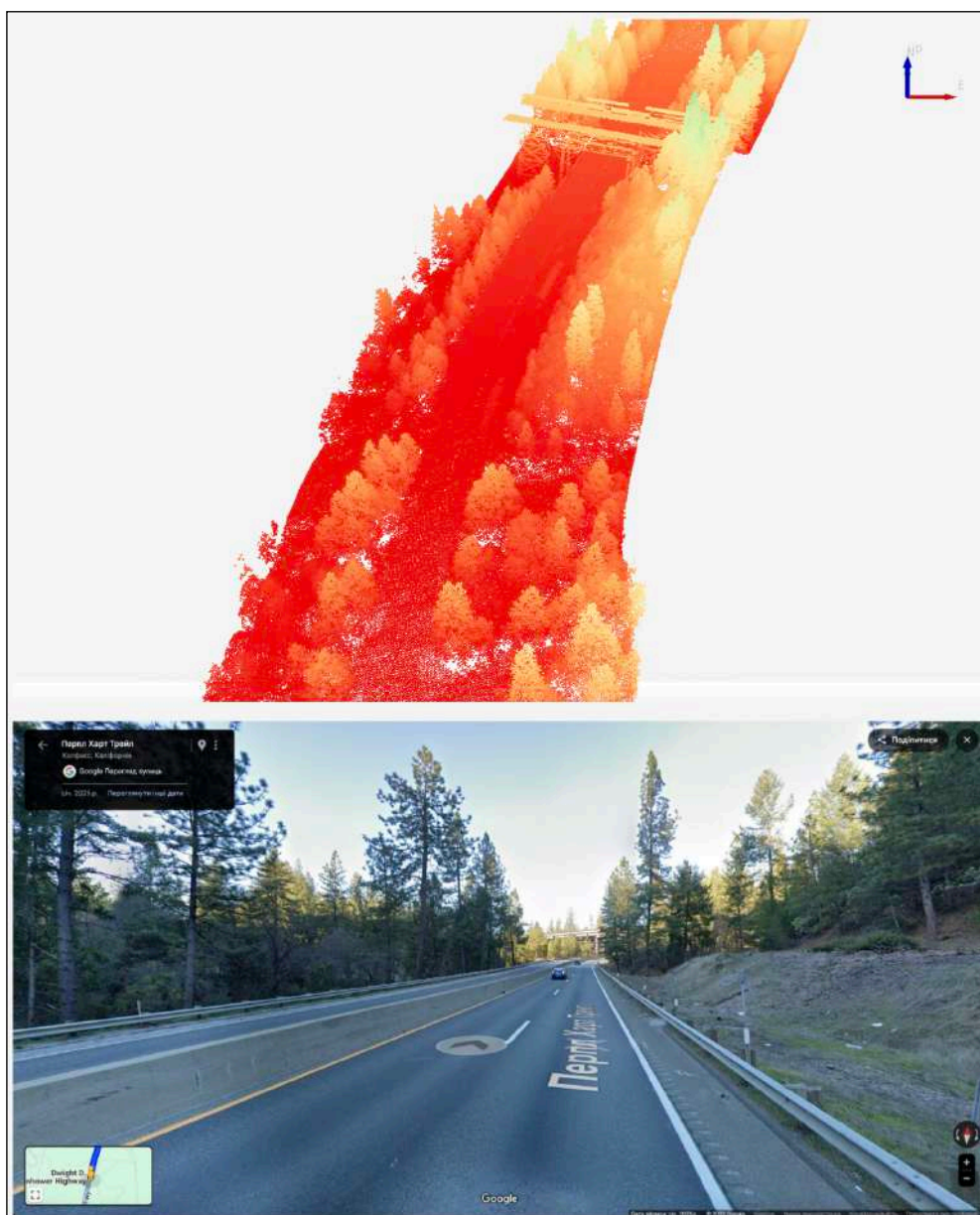
Рисунок 2.11 – Тривимірна візуалізація фрагменту ділянки траси I-80 за допомогою хмари точок у середовищі QGIS та інструменту StreetView від GM
