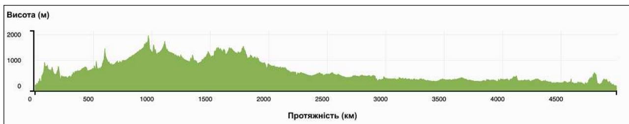
Рисунок 3.13 – Профіль рельєфу території, якою прокладено трасу I-90, згенерований у GH на основі DEM SRTM1.
