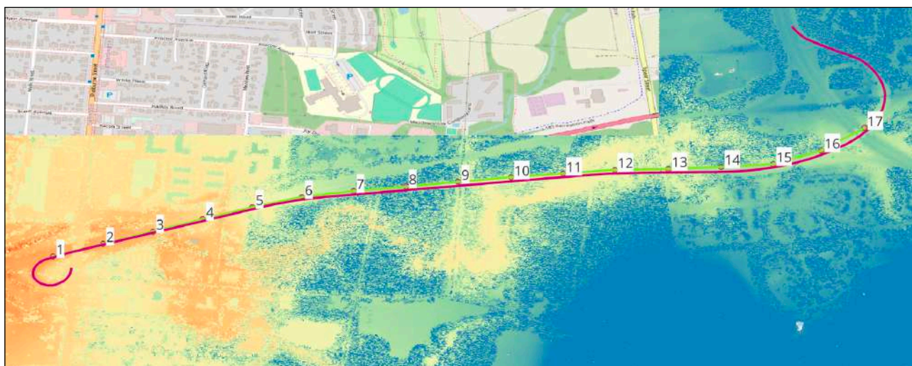
Рисунок 3.3 – Положення контрольних точок сегментів та загальної площинної геометрії траси I-189 на фоні лазерного знімання та шару OSM Standard в QGIS.
