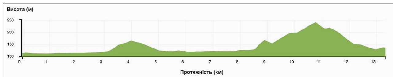
Рисунок 3.21 – Профіль рельєфу території, якою прокладено автодорогу М-08, згенерований у GH на основі DEM SRTM1.
