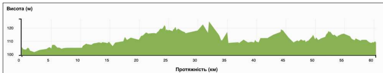
Рисунок 3.33 – Профіль рельєфу території, якою прокладено автодорогу М-24, згенерований у GH на основі DEM SRTM1.
