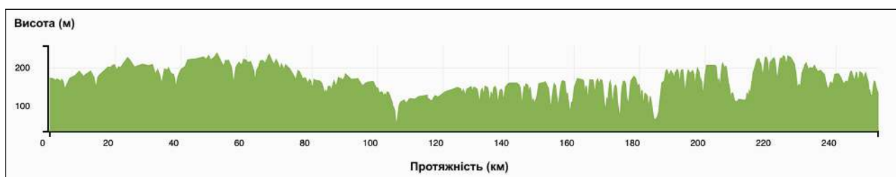
Рисунок 3.25 – Профіль рельєфу території, якою прокладено автодорогу М-13, згенерований у GH на основі DEM SRTM1.
