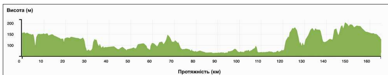
Рисунок 3.31 – Профіль рельєфу території, якою прокладено автодорогу М-22, згенерований у GH на основі DEM SRTM1.
