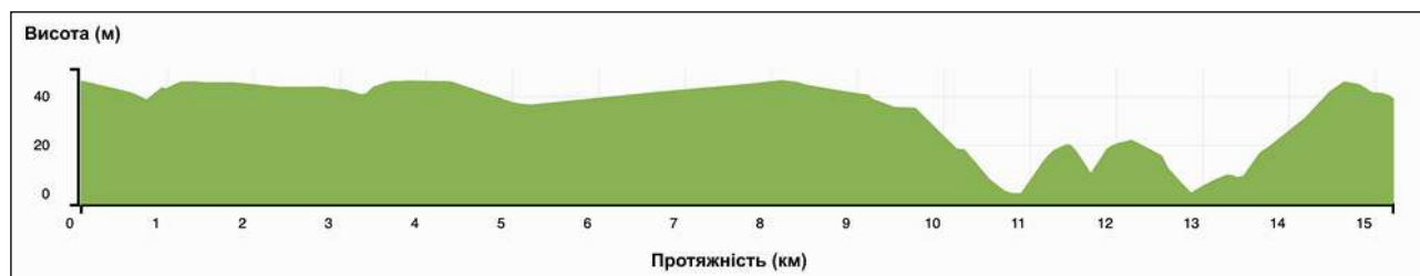
Рисунок 3.36 – Профіль рельєфу території, якою прокладено автодорогу М-27, згенерований у GH на основі DEM SRTM1.
