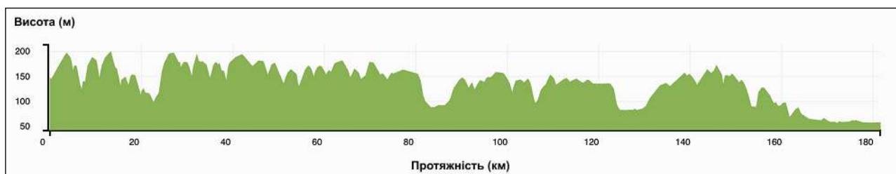
Рисунок 3.38 – Профіль рельєфу території, якою прокладено автодорогу М-29, згенерований у GH на основі DEM SRTM1.
