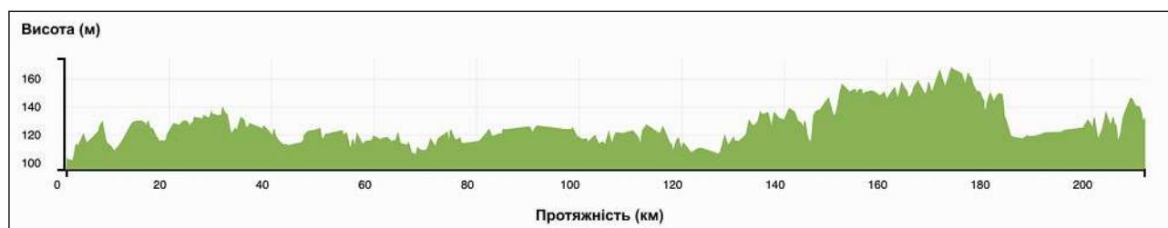
Рисунок 3.16 – Профіль рельєфу території, якою прокладено автодорогу М-01, згенерований у GH на основі DEM SRTM1.
