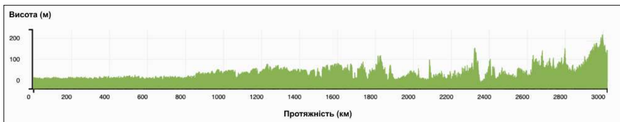
Рисунок 3.14 – Профіль рельєфу території, якою прокладено трасу I-95, згенерований у GH на основі DEM SRTM1.
