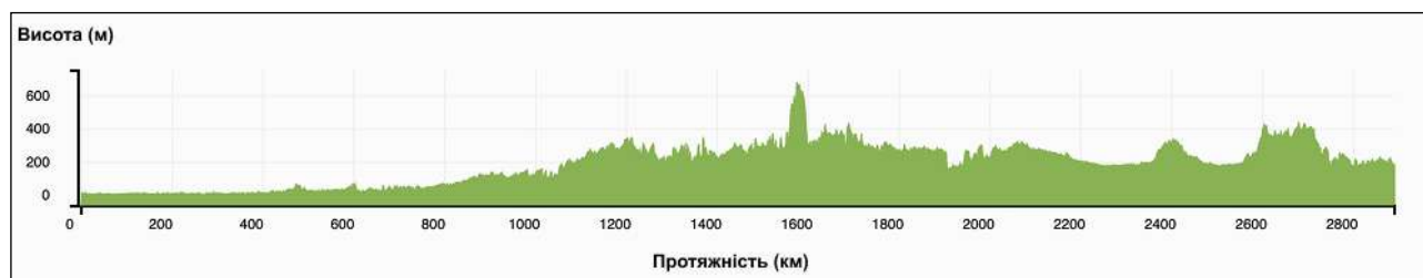
Рисунок 3.12 – Профіль рельєфу території, якою прокладено трасу I-75, згенерований у ГН на основі DEM SRTM1.
