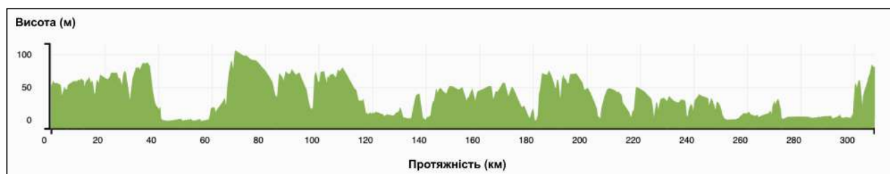
Рисунок 3.26 – Профіль рельєфу території, якою прокладено автодорогу М-15, згенерований у GH на основі DEM SRTM1.
