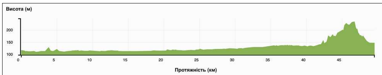
Рисунок 3.32 – Профіль рельєфу території, якою прокладено автодорогу М-23, згенерований у GH на основі DEM SRTM1.
