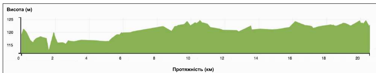
Рисунок 3.35 – Профіль рельєфу території, якою прокладено автодорогу М-26, згенерований у GH на основі DEM SRTM1.
