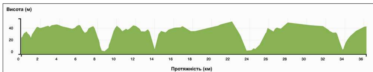
Рисунок 3.37 – Профіль рельєфу території, якою прокладено автодорогу М-28, згенерований у GH на основі DEM SRTM1.
