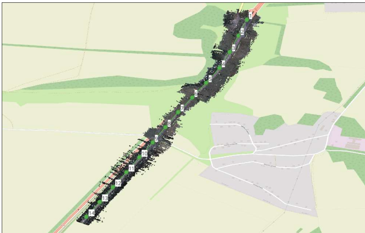
Рисунок 3.2 –Положення контрольних точок сегментів та загальної площинної геометрії ділянки траси М-03 на фоні лазерного знімання та шару OSM Standard в QGIS.
