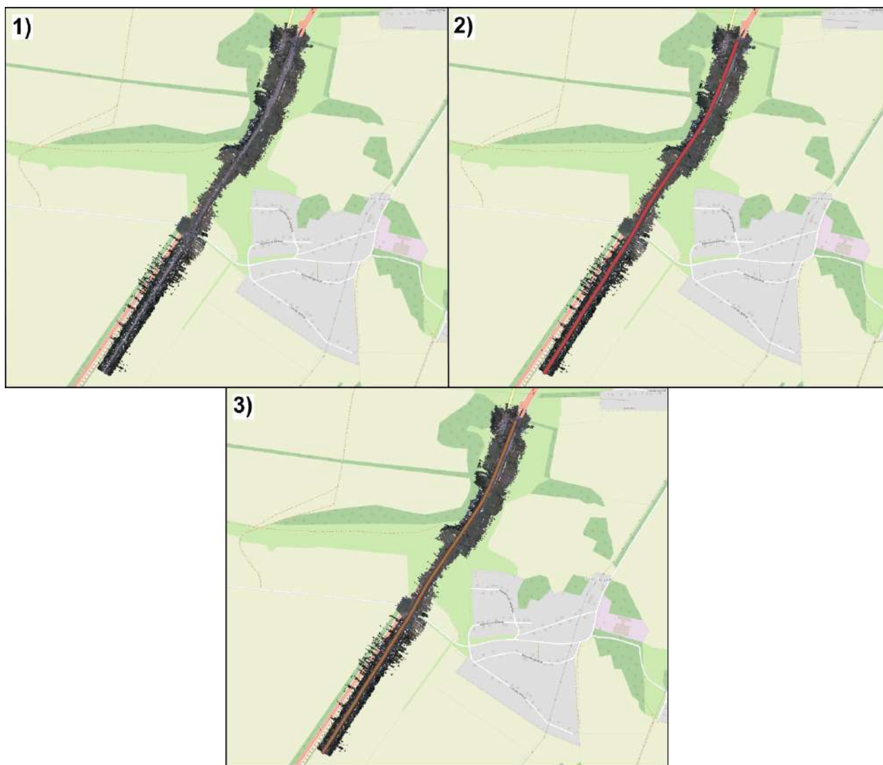
Рисунок 3.6 – Етапи підготовки просторових даних рівнинної місцевості, де прокладено ділянку траси М-03 для подальших розрахунків: 1) завантаження даних лазерного сканування ; 2) створення полігону, де прокладено ділянку траси; 3) отримання лінії вісі траси як центральної лінії полігону (лазерне знімання USGS та шар OSM Standard із візуалізацією в QGIS).
