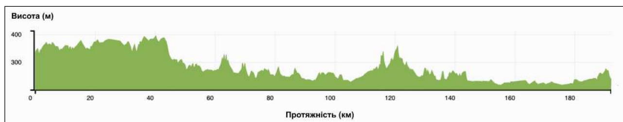
Рисунок 3.22 – Профіль рельєфу території, якою прокладено автодорогу М-09, згенерований у GH на основі DEM SRTM1.
