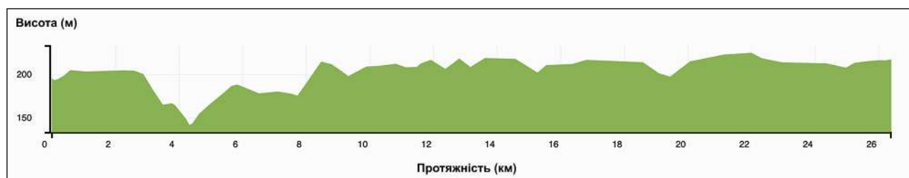
Рисунок 3.29 – Профіль рельєфу території, якою прокладено автодорогу М-20, згенерований у GH на основі DEM SRTM1.
