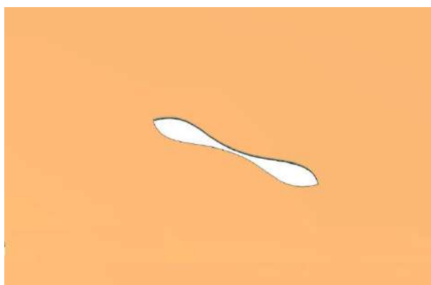
Рис. 2.27. Надширокосмугова щілина з патенту [33], що прорізана вібраторно-щілинний випромінювач нескінченному екрані
