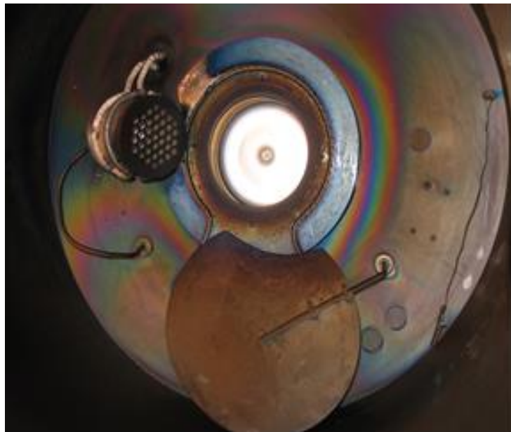
Рис. Б2. Зображення магнетрону та ВЧ індукційного джерела плазми в КПС з боку робочої камери
