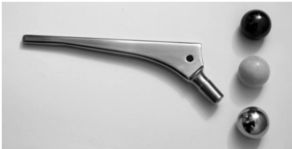
Рис. Б13. Однополюсний протез тазостегнового суглобу з неіржавіючої сталі з керамічним багатшаровим покриттям AlN/Al_2O_3 головки суглоба. Протез виготовлено фірмою "Інмайстерс", захисне покриття нанесено на установці КПС в ХНУ імені В.Н. Каразіна.
