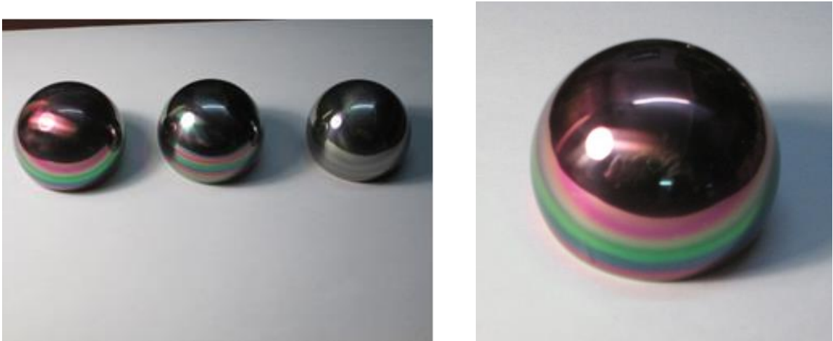
Рис. Б12. Головки тазостегнового суглобу з неіржавіючої сталі з керамічним багатшаровим покриттям AlN/Al_2O_3 .
