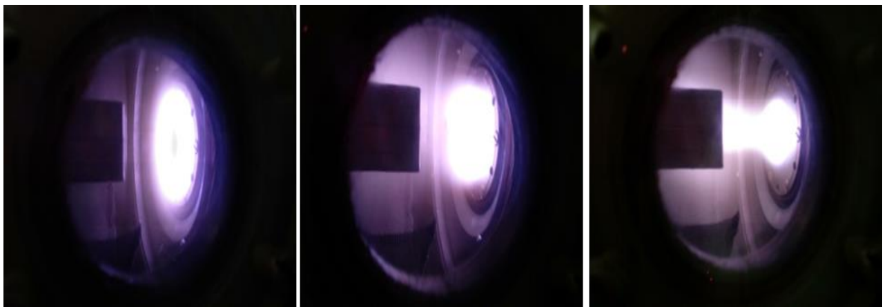
Рис. 3.14. Зображення магнетронного розряду в трьох режимах при різних струмах соленоїда I_c : I_c = 0 (а), I_c = 2 А (б), I_c = 4 А (с)
