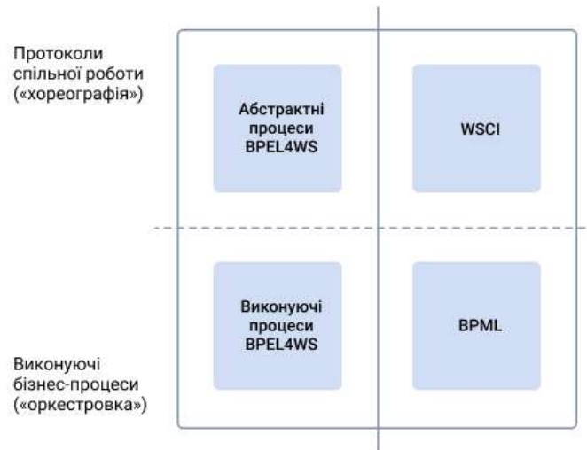
Рисунок 2.13. Приклад взаємозв'язку стандартів «оркестровки» та «хореографії» на мовах оброблення й виконання бізнес-процесів за допомогою веб-сервісів BPEL4WS, WSCI та BPML у моделі GaaP, що працює [210]
