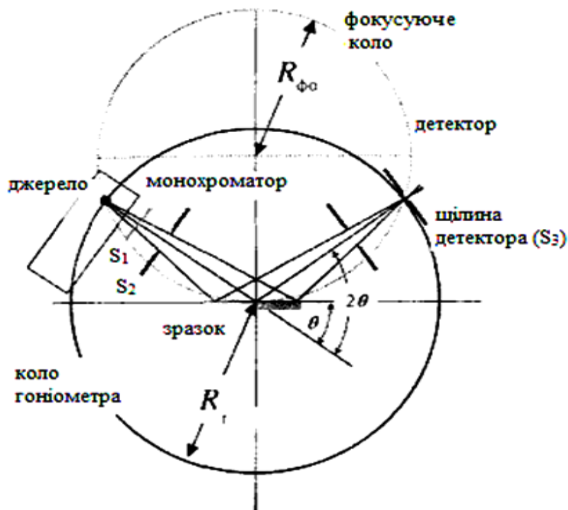
Рис.2.2. Схема зйомки по Бреггу – Брентано: S_1 і S_2 - щілини, що обмежують первинний пучок; S_3 - вхідна щілина детектора (лічильника)
