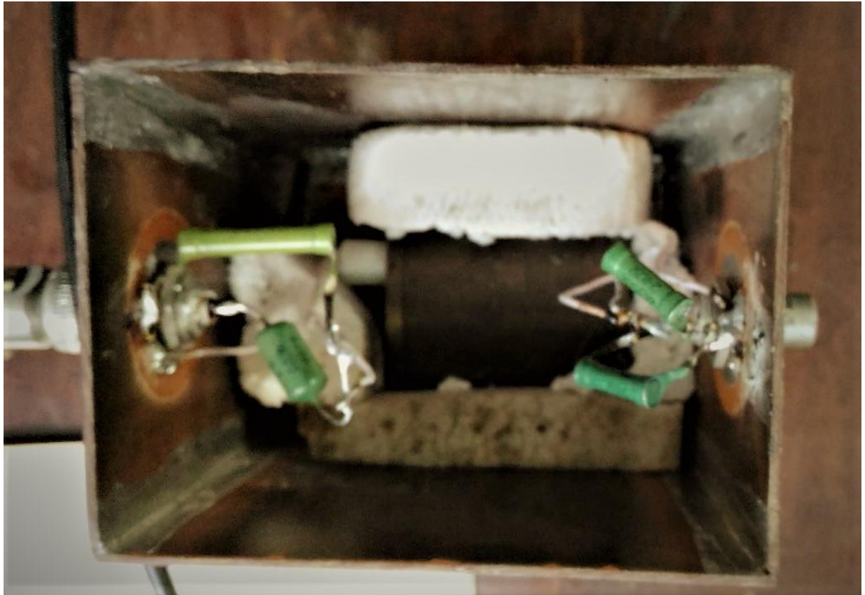
Рис. 3.7. Вимірювальна схема електричного зонда
