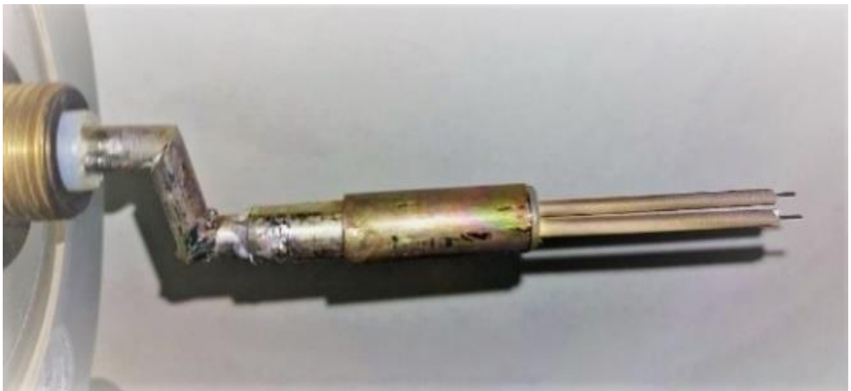
Рис. 3.10. Подвійний зонд для вимірювання електронної температури
