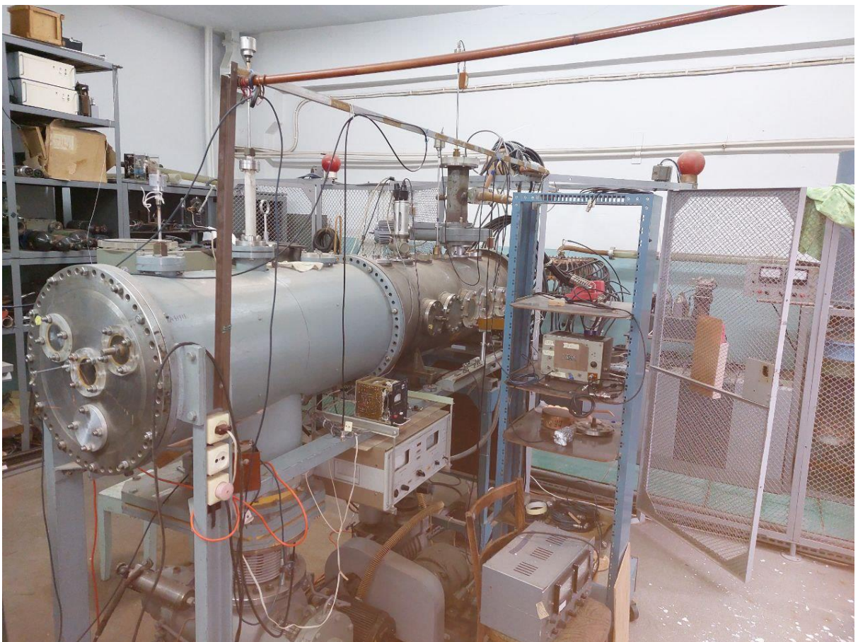
Рис. 2.1 Експериментальний стенд магнітоплазмовий компресор: вакуумна камера та діагностичне обладнання
